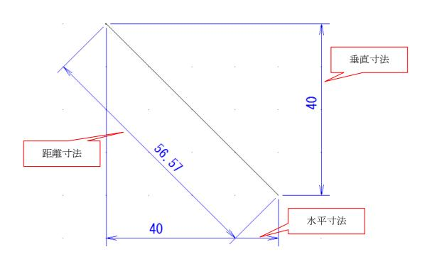
一目瞭然ですね。「垂直寸法」は要素の垂直の高さの寸法を出します。 「水平寸法」は要素の水平の長さの寸法を出します。 「距離寸法」は線の実距離を出します。
