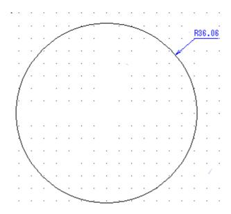
引き出し半径寸法が表示されたら完了です。
