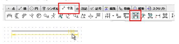
移動させたい寸法をカーソルで選択(対象寸法がオレンジ色になればOK)し、クリックします。 寸法がピンク色で表示され、寸法の数字が四角に変化。カーソルについてくるようになるので、
