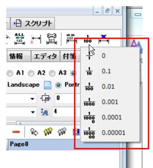
「寸法桁数」ボタンを押下すると、上記のようなプルダウンリストが表示されます。ここから表示させたい桁数をカーソルで選択します。
