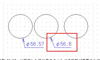
寸法桁数「1/10」に設定した後に表示させた寸法桁数が変更されています。
