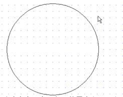
寸法を表示させたい位置をクリックします。 クリック位置に半径が表示されれば完了です。
