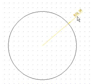
引き出し直線を短くしたい半径寸法を選択します。
