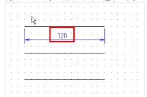
偽尺をONにします。「寸法」タブ→「偽尺」コマンドを押下します。
