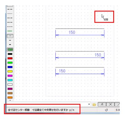
カーソルに「Y/N」アイコンが表示&操作指示文に「寸法線全て中央寄せを行いますか y/n」と表示されるので、作図画面内の任意の位置で左クリック押下
